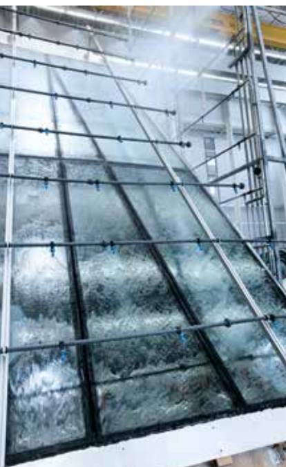
Testarea etanșeității fațadei în Centrul Tehnologic Schüco Testing the watertightness of a façade in the Schüco Technology Center
